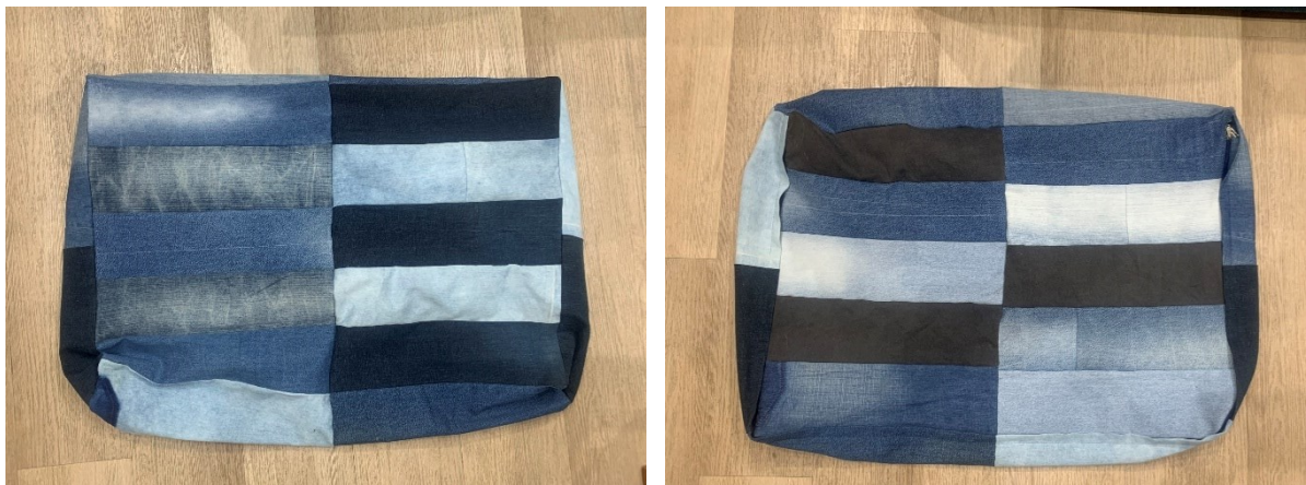
Figura 37 - (a) Frente e (b) Verso do Cama Almofada M pós união das partes, via costura, com a máquina interlock e colocação dos zíperes.
