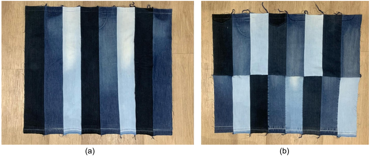
Figura 22 - (a) Frente e (b) Verso do Colchonete G pós união das partes via costura com a máquina interlock.
