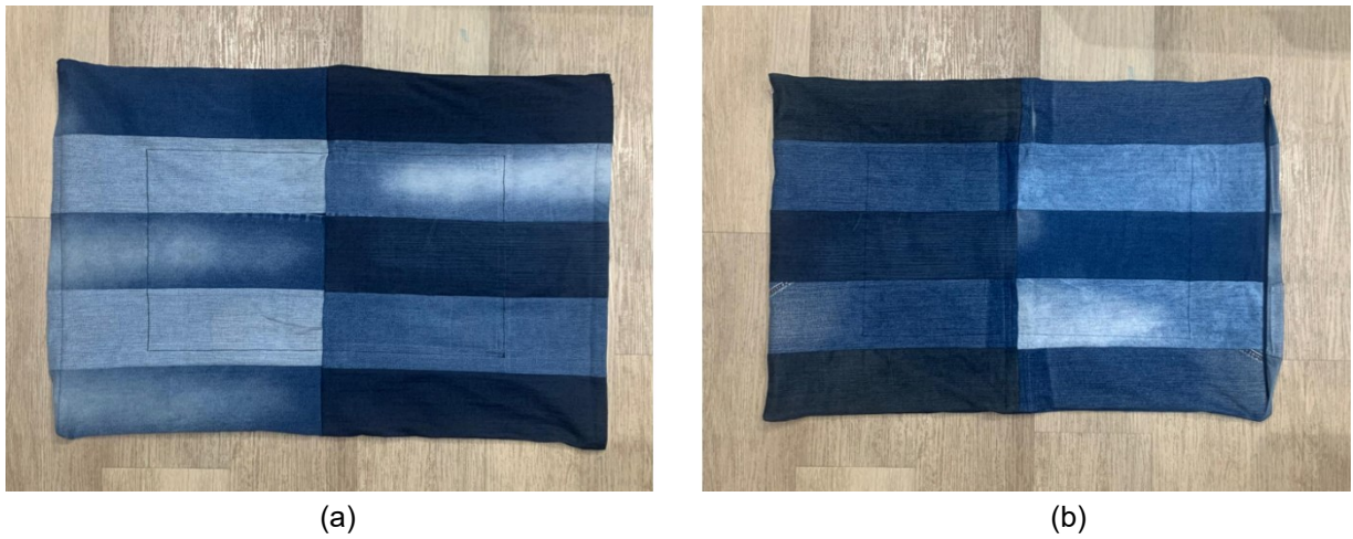
Figura 33 - (a) Frente e (b) Verso do Colchonete Almofada M pós união das partes, via costura, com a máquina interlock e colocação dos zíperes.
