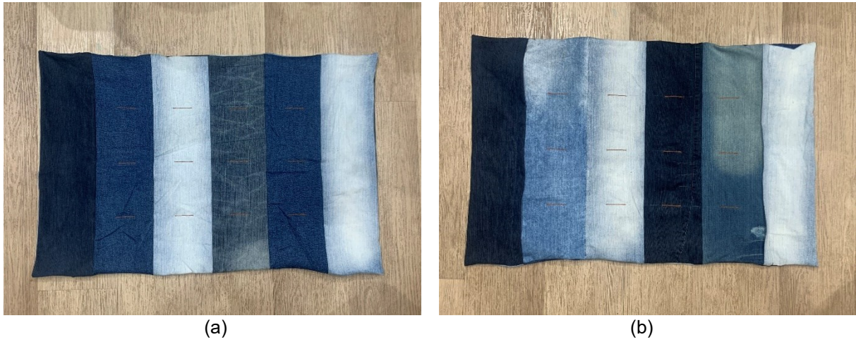
Figura 27 - (a) Frente e (b) Verso da Almofada Futon M pós união das partes, via costura, com a máquina interlock e colocação dos zíperes.
