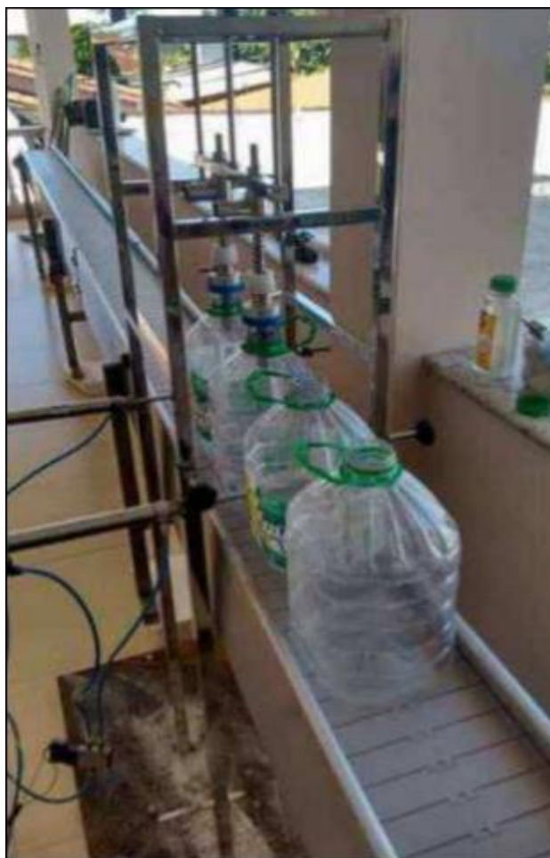
Figura 1.1 – Esteira metálica - Envase de suco de laranja
