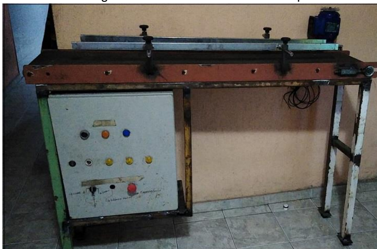
Figura 3.7 - Esteira com a base e o painel
