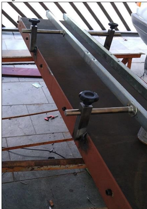
Figura 3.5 - Esteira com o auxiliador de alinhamento
