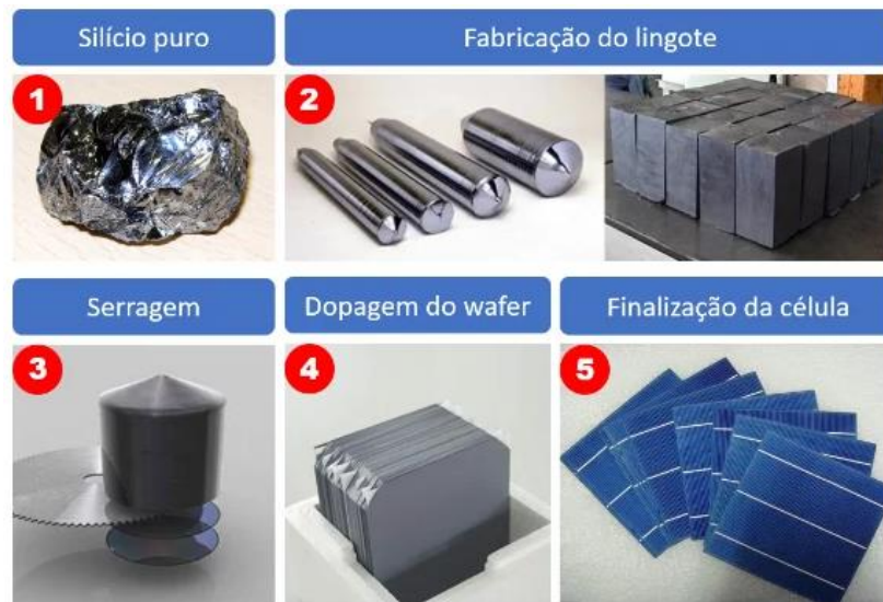
Figura 28 - Etapas de produção de uma Célula Fotovoltaica.
