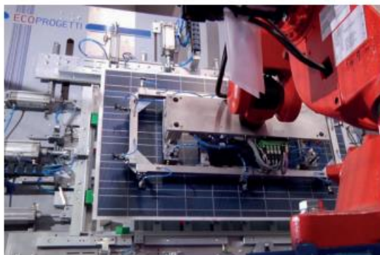
Figura 27 - Máquina de acabamento do módulo fotovoltaico.
