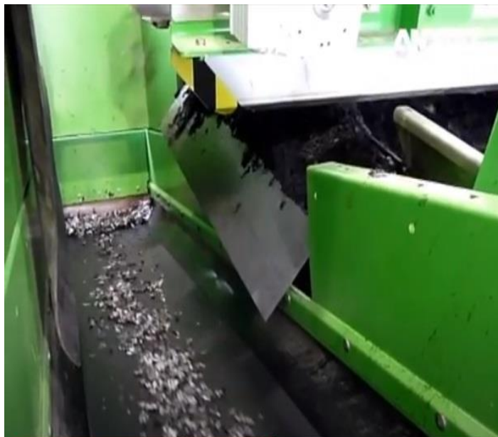
Imagem 4 – Processos da reciclagem – Esteira magnética para separação dos metais
