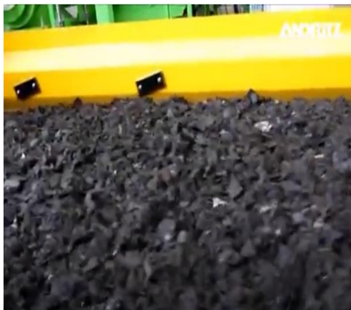
Imagem 3 – Processos da reciclagem – Material após passar pelo moinho triturador
