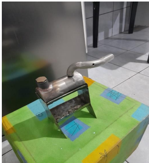
Figura 18: Início da construção da caldeira de inox
