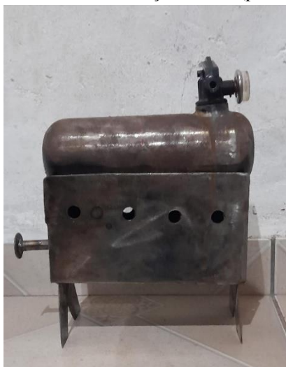
Figura 20: Caldeira de aço carbono (protótipo 3).
