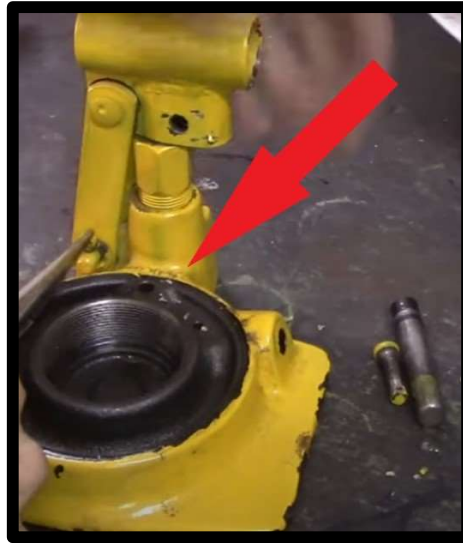
Figura 23 – Orifício de entrada do óleo para pistão injetor.
