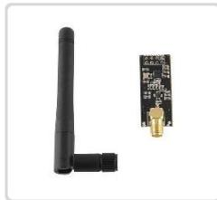
Figura 4 – Módulo de rádio frequência NRF24L01 (Fonte: Autor, 2021)
