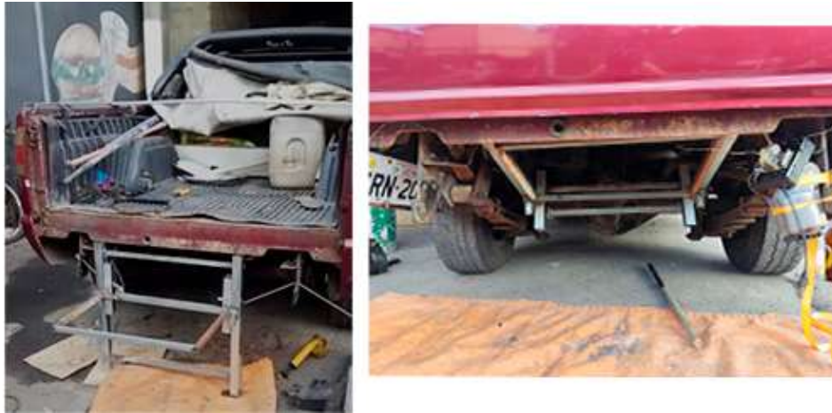
Figura 9 Ensaio da instalação e Recolhimento da Plataforma
