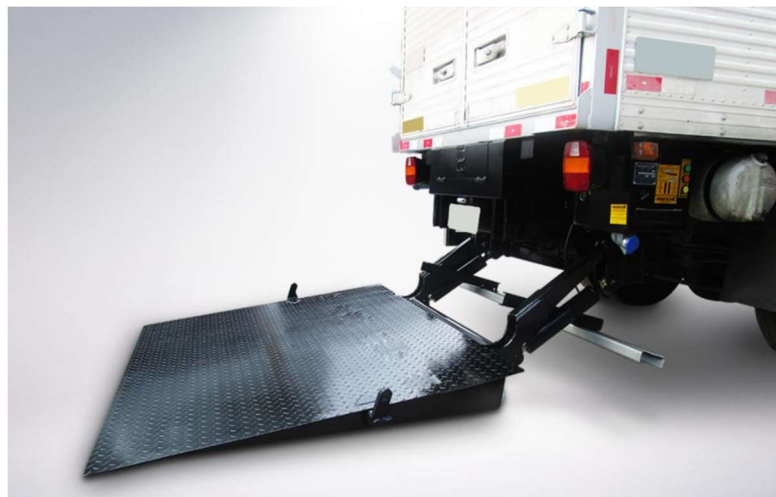
Figura 1. Plataforma instalada em caminhão
