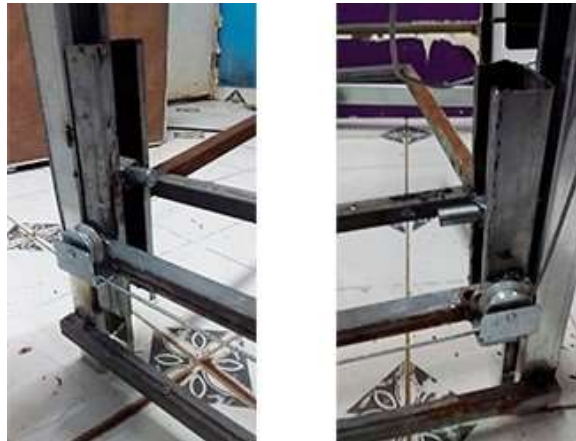
Figura.4 Teste da elevação com sistema de roldanas
