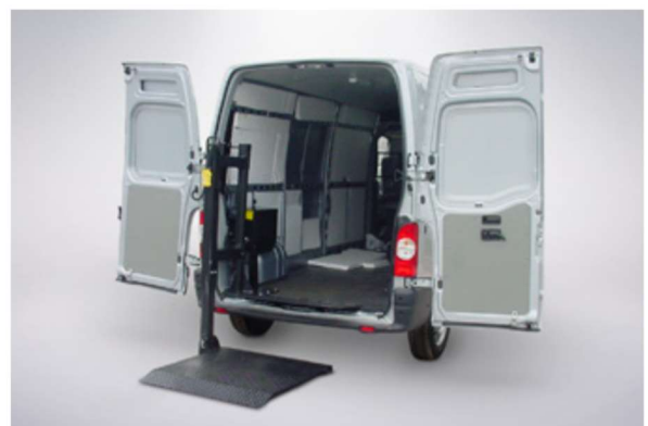
Figura.2 Plataforma em repouso no Furgão / Plataforma em trabalho no Furgão
