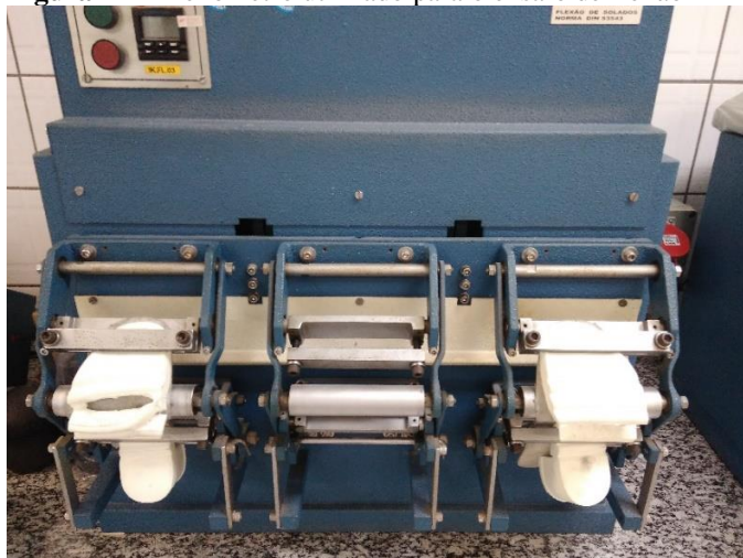
Figura 11 – Flexômetro utilizado para o ensaio de flexão
