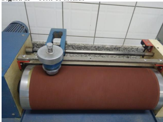
Figura 13 – Teste de abrasão
