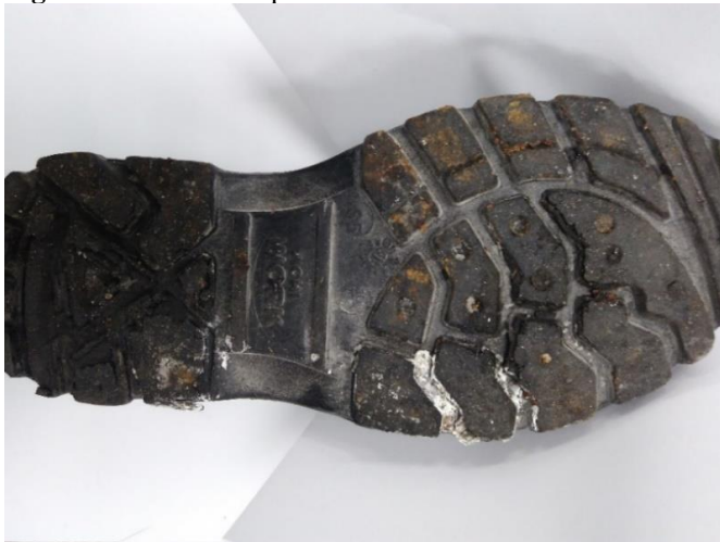
Figura 7 – Solado em processo de hidrólise
