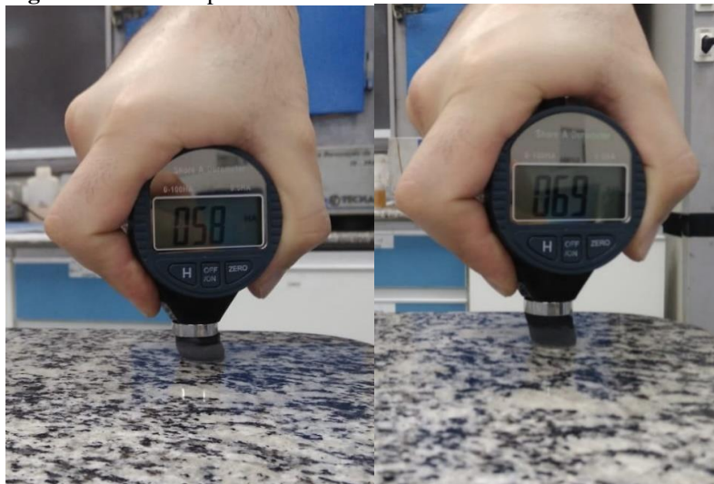
Figura 15 – Dureza poliuretano x dureza borracha nitrílica
