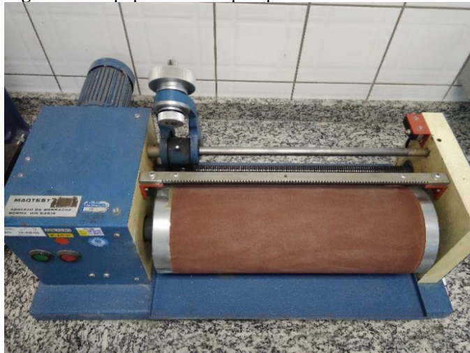
Figura 10 - Equipamento Maqtest para ensaio de abrasão
