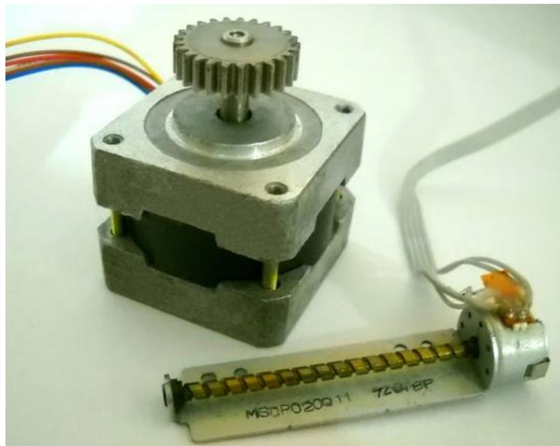
Figura 5: Motor de passo Fonte: própria
