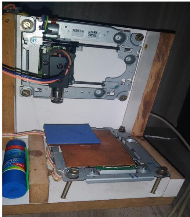
Figura 39: CNC Laser construído Fonte: Criação própria
