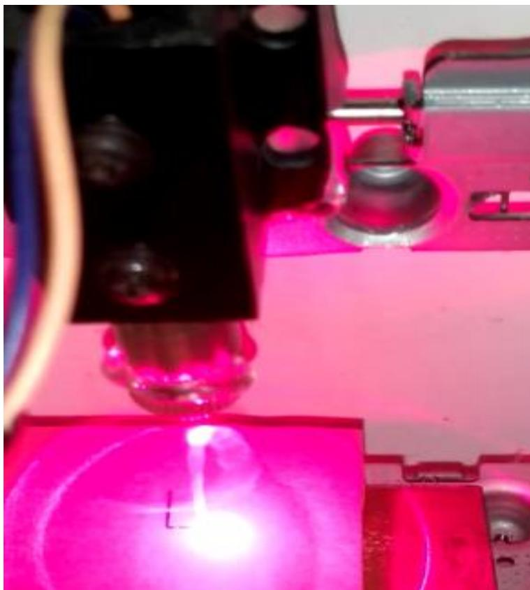
Figura 41: Gravação em Laser do protótipo operando Fonte: Criação própria
