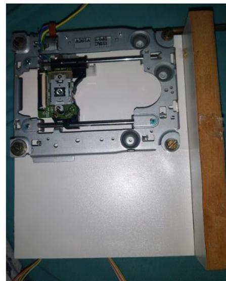
Figura 32: Eixos montados na estrutura
