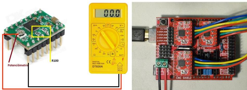
Figura 22: CNC Shield montado Fonte: própria.
