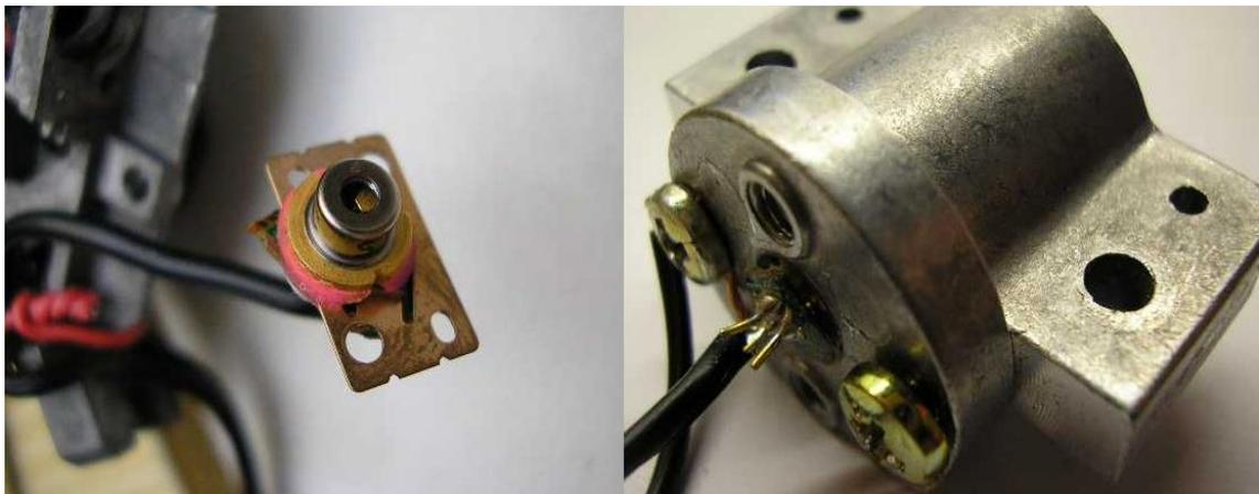
Figura 17: Diodo Laser retirado Fonte: própria.
