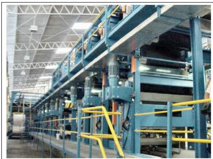
Figura 16: Vista lateral de uma máquina Slasher Dye
