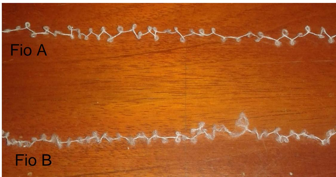
Figura 34: Detalhe do fio de trama sem defeitos (Fio A) e com defeitos (Fio B).
