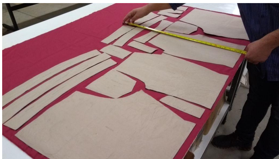
Figura 10: Medição do comprimento do tecido utilizado no encaixe manual Fonte: Elaborado pelos autores
