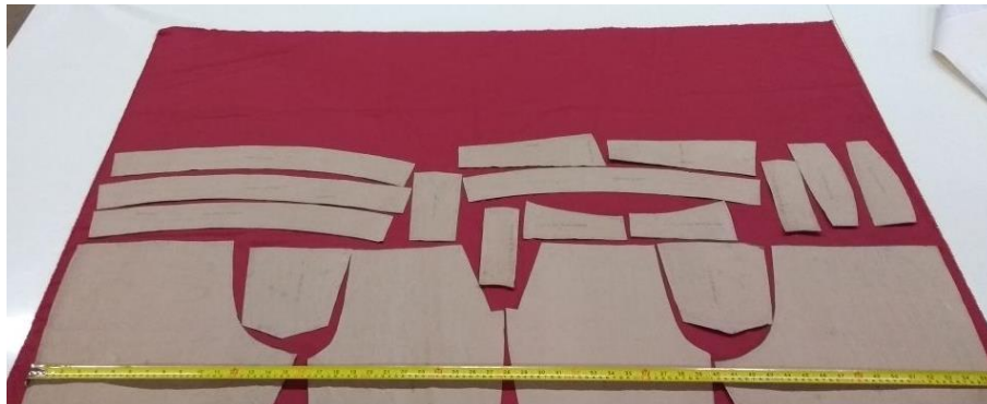
Figura 9: Medição da largura do tecido utilizado no encaixe manual Fonte: Elaborado pelos autores
