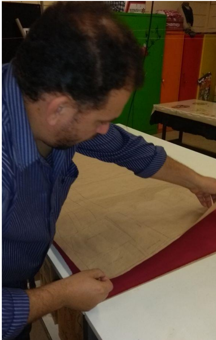
Figura 15: Colagem da folha molde no tecido Fonte: Elaborado pelos autores
