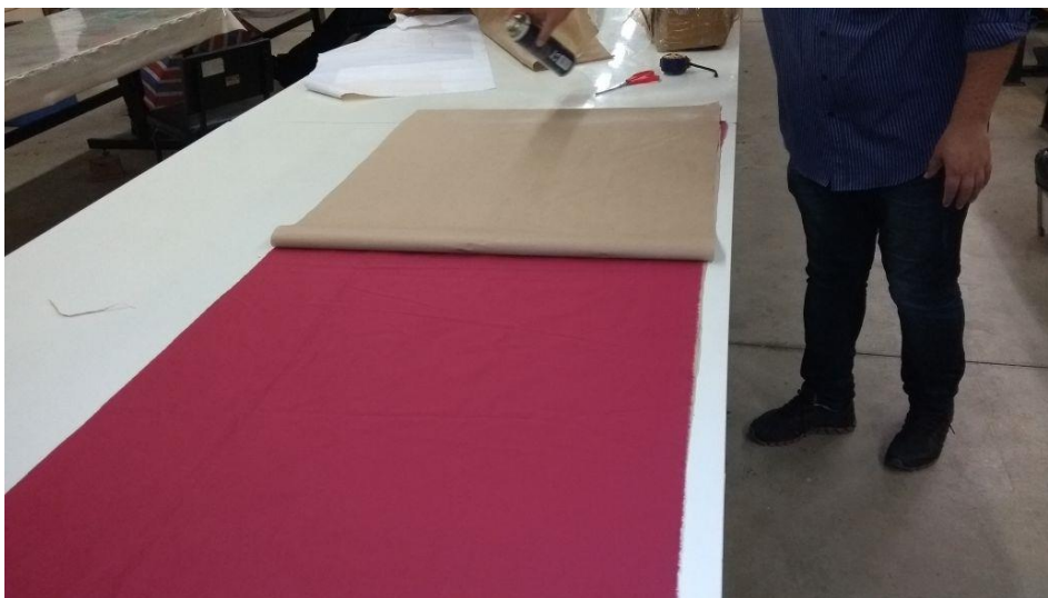
Figura 14: aplicação de cola na folha molde Fonte: Elaborado pelos autores
