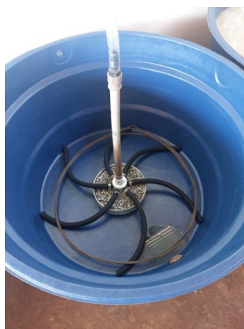
Figura 22: caixa d' água com as mangueira que produzem o oxigênio
