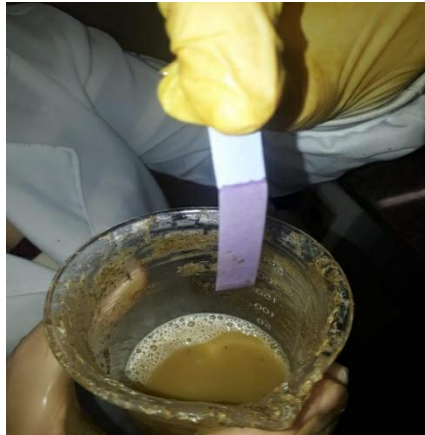
Figura 37 – Resultado do pH analisado no papel tornassol.
