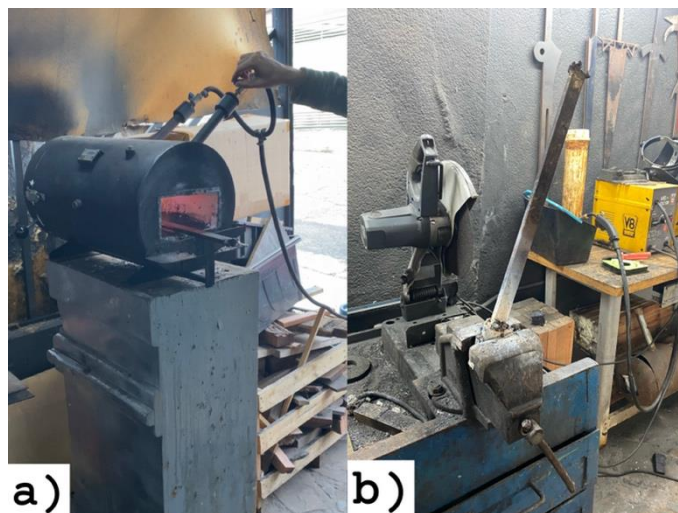
Figura 24: a) forno a gás; b) pedaço de aço com cabo fundido. Fonte: Acervo do autor.
