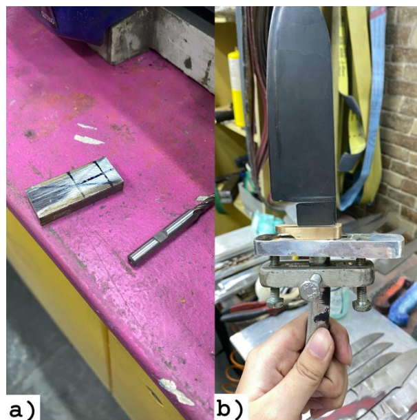
Figura 28: a) pedaço de latão marcado, b) faca e guarda fixado juntos. Fonte: Acervo do autor .
