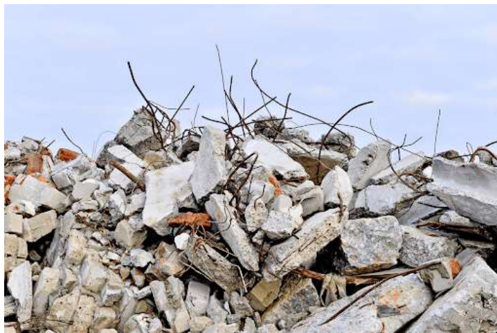
Figura 4 - Resíduos de Demolições da Construção Civil
