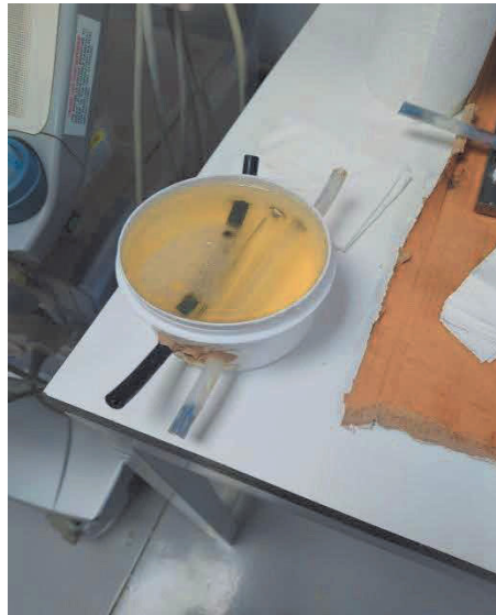
Figura 19 – Imagem do teste de um Phantom com gelatina
