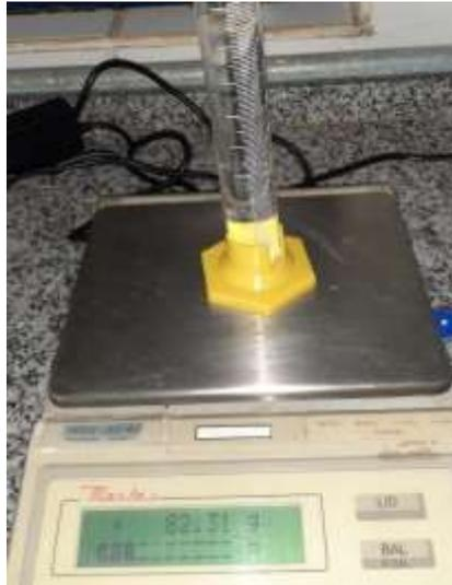
Figura 9: pesagem da água destilada.
