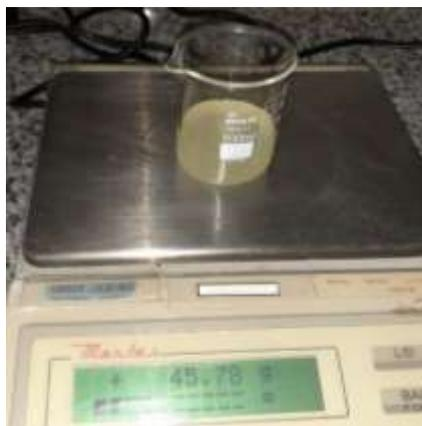
Figura 4: Pesagem do lauril éter sulfato de sódio
