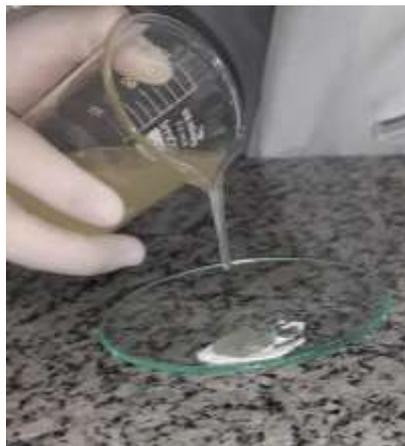
Figura 6: junção do lauril éter sulfato de sódio com o nipagin
