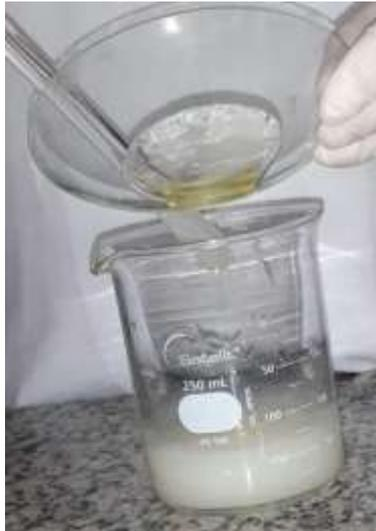
Figura 11: junção do dietanolamina com os demais ingredientes.
