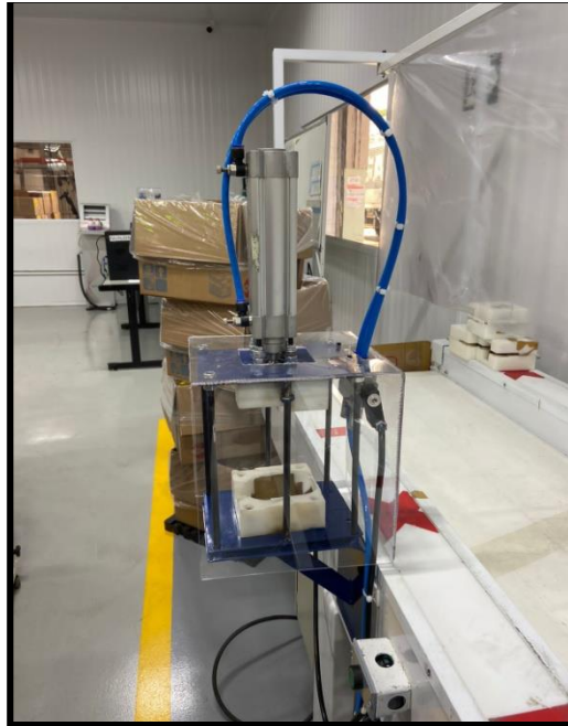
Figura 8: instalação da prensa pneumática na máquina
