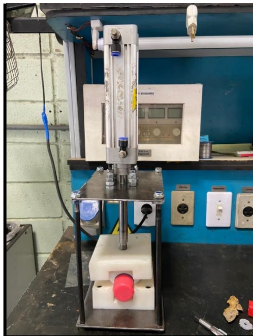
Figura 2: Primeira etapa do desenvolvimento da prensa: desenvolvimento da base, fixação da matriz e fixação do atuador pneumático
