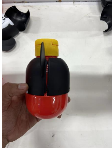
Figura 10: garrafa montada e pronta para por na prensa pneumática
