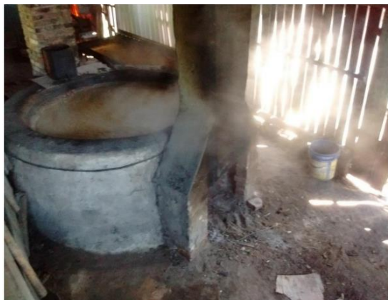
Figura 3 - Produção artesanal de açúcar mascavo e melado na etapa de cozimento do caldo
