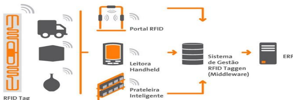
Figura 10. Um exemplo do funcionamento da etiqueta RFID
