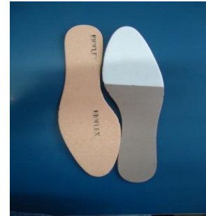
Figura 18. :Palmilha com reforço, EVA, palntex, fibra . Fonte – O Autor.
