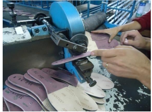
Figura 35.: Máquina para fresar palmilhas Fonte: O Autor.
