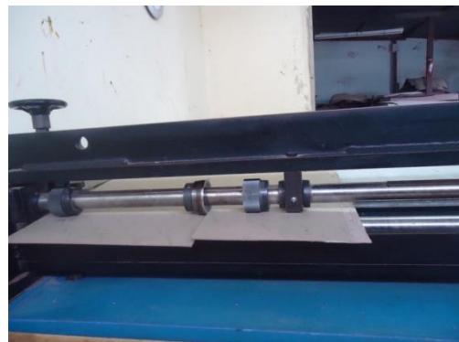
Figura 31.: Máquina para cortar tiras. Fonte: O Autor.
