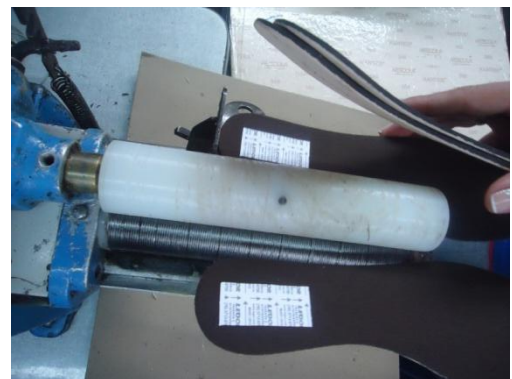
Figura38.: Máquina de passar cola em palmilhas Fonte: O Autor.
