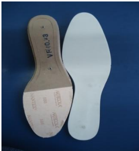
Figura 17. :Palmilha com reforço, EVA, plantex, fibra e esquino. Fonte – O Autor.
