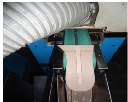
Figura 34.: Máquina de Abrir canaleta Fonte: O Autor.
