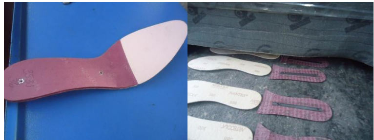
Figura 20. :Palmilha com reforço, EVA, plantex, fibra rosa e esquino. Fonte – O Autor.
