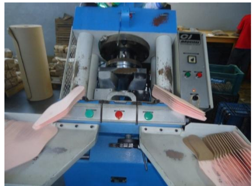
Figura 37.: Máquina para moldar palmilhas Fonte: O Autor.
