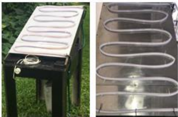
Figura 6: Fotos do reator construído visto de longe (à esquerda) e perto (à direita), com a mangueira pintada pela metade instalada sobre a placa de alumínio.
