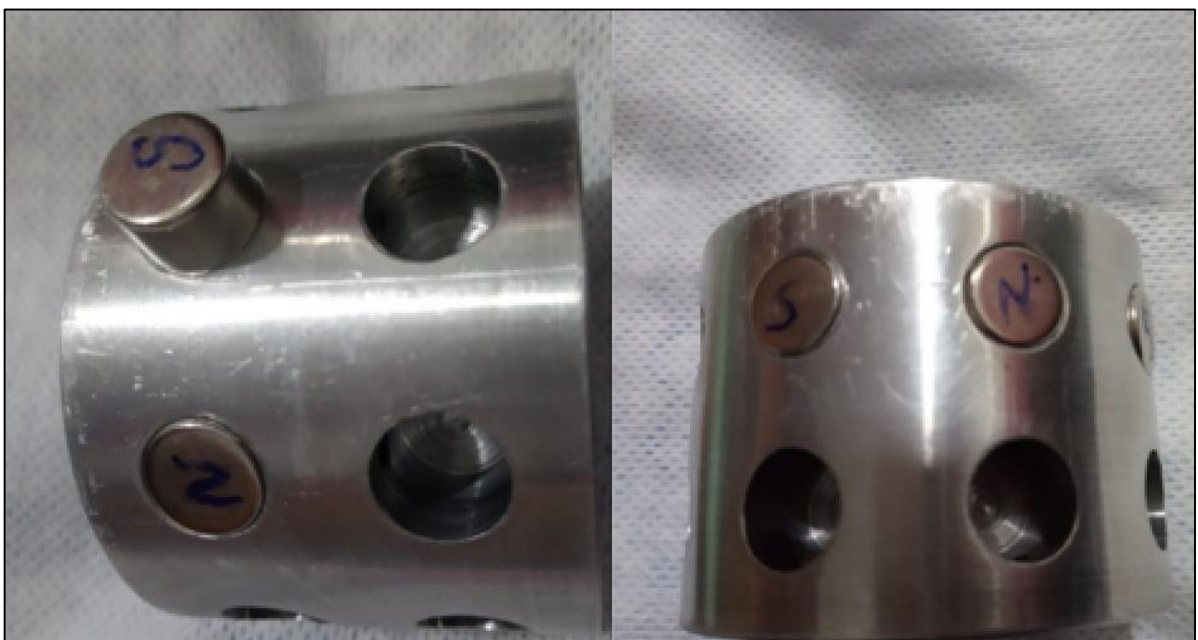
Figura 48 - Ímãs sendo inseridos nas cavidades da peça PME.05.
