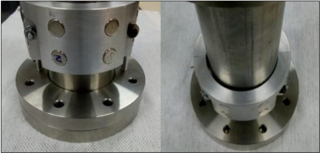
Figura 76 – Acoplamento externo PME2.04 adicionado ao protótipo.
