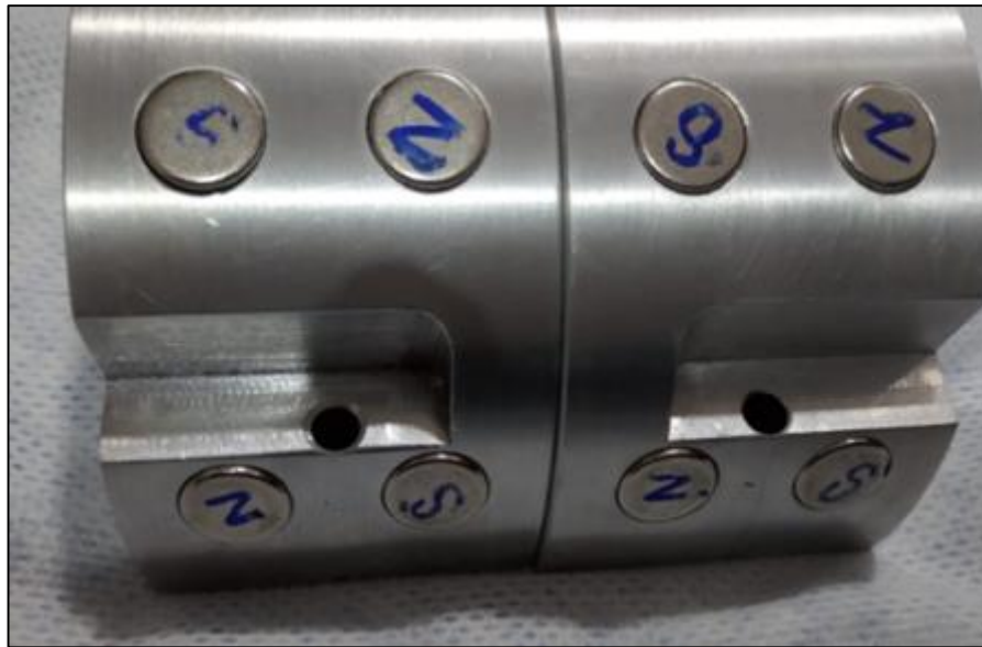
Figura 51 – Peça PME.04 com os ímãs inseridos nas cavidades.
