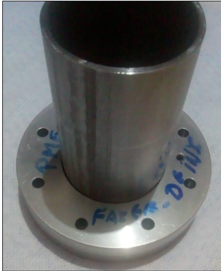
Figura 55 – Conexão do tubo principal com os flanges de fechamento.
