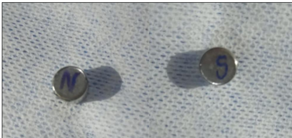
Figura 46 – Ímãs com a marcação dos polos magnéticos.
