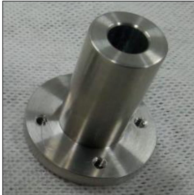
Figura 69 – Complementação do eixo para fixação.
