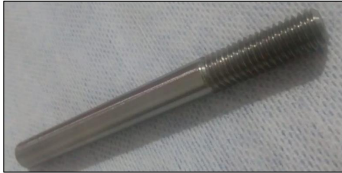
Figura 12 – Eixo central retificado pós usinagem.
