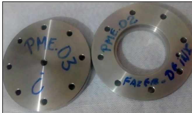
Figura 13 – Flanges usinados em aço inoxidável AISI 304L.
