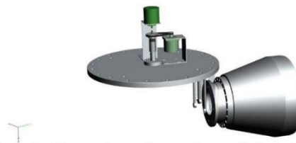
Figura 1 - Sistema de movimentação acoplado à câmara de vácuo
