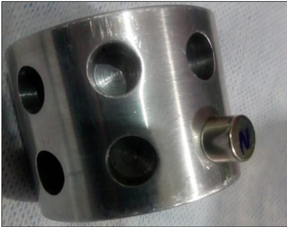
Figura 66 - Imã sendo inserido na peça PME2.05.
