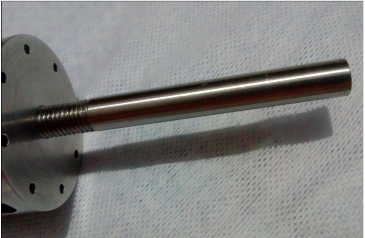
Figura 59 – Acoplamento interno com o eixo axial fixado.
