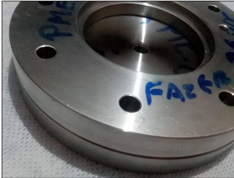
Figura 52 – Flanges de fechamento antes da junção por parafusos.
