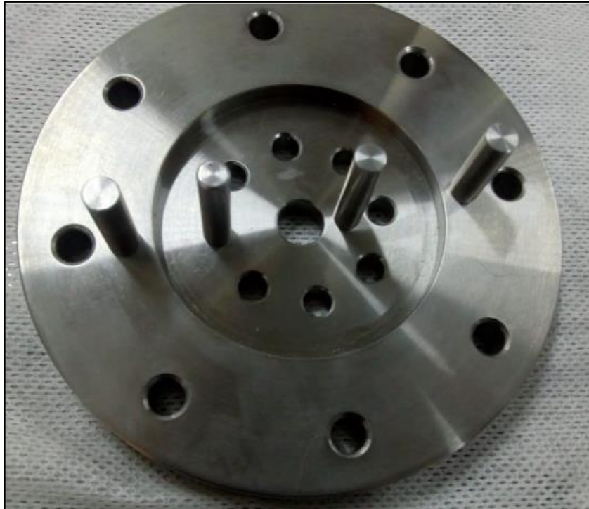
Figura 58 – Flange de fechamento PME.06 com os tops acoplados.
