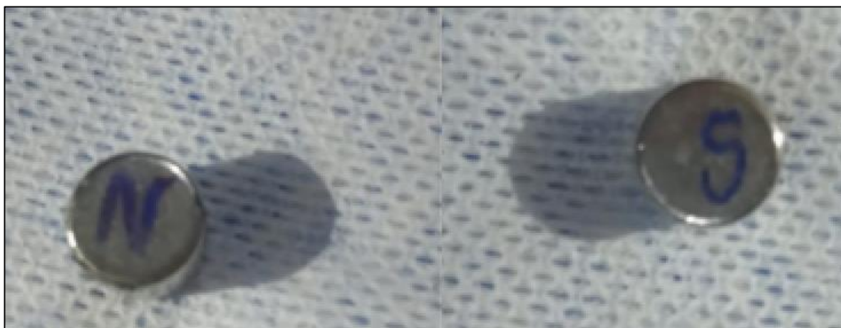
Figura 64 – Ímãs com as marcações dos polos.
