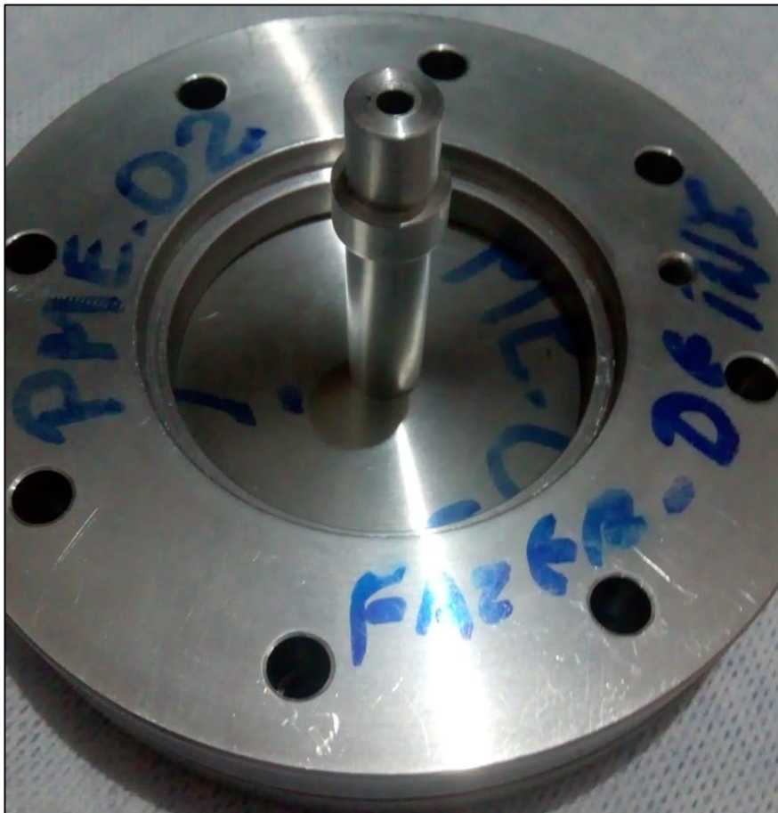
Figura 54 – Flange PME.03 com o eixo central posicionado.
