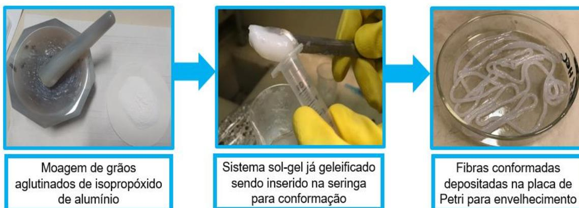
Figura 8: Preparação dos materiais para a conformação das fibras de alumina.
