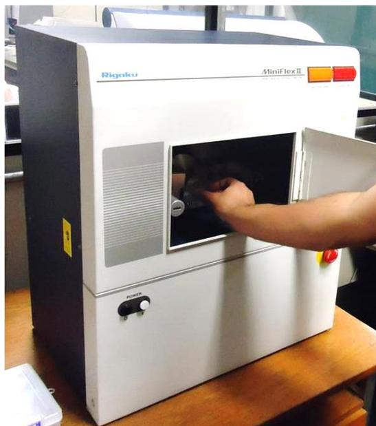
Figura 17: Difratômetro de raios X utilizado para análise das fibras produzidas.
