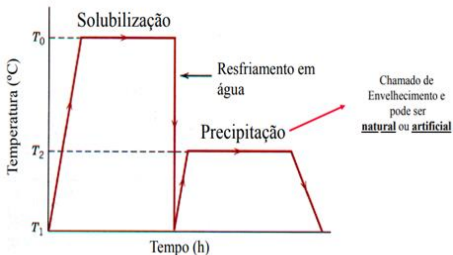
Figura 4 : Gráfico demonstrativo dos tratamentos térmicos de solubilização e envelhecimento [10]
