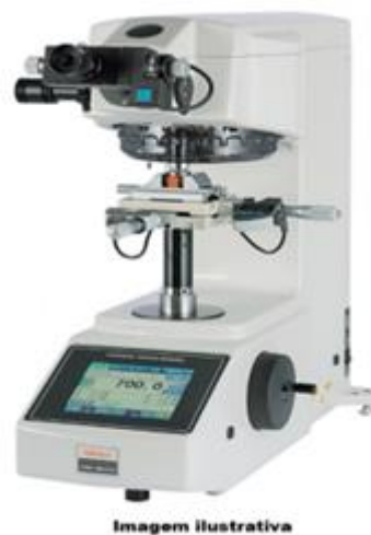
Figura 8: Microdurômetro Vickers Mitutoyo (modelo HM 210)
