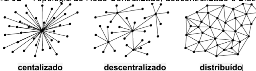
Figura 01 – Topologia de Rede Centralizado, descentralizado e Distribuído
