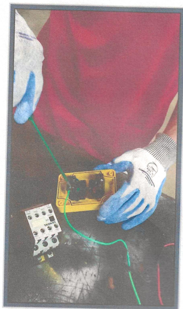
Figura 17 - Manutenção e teste da botoeira
