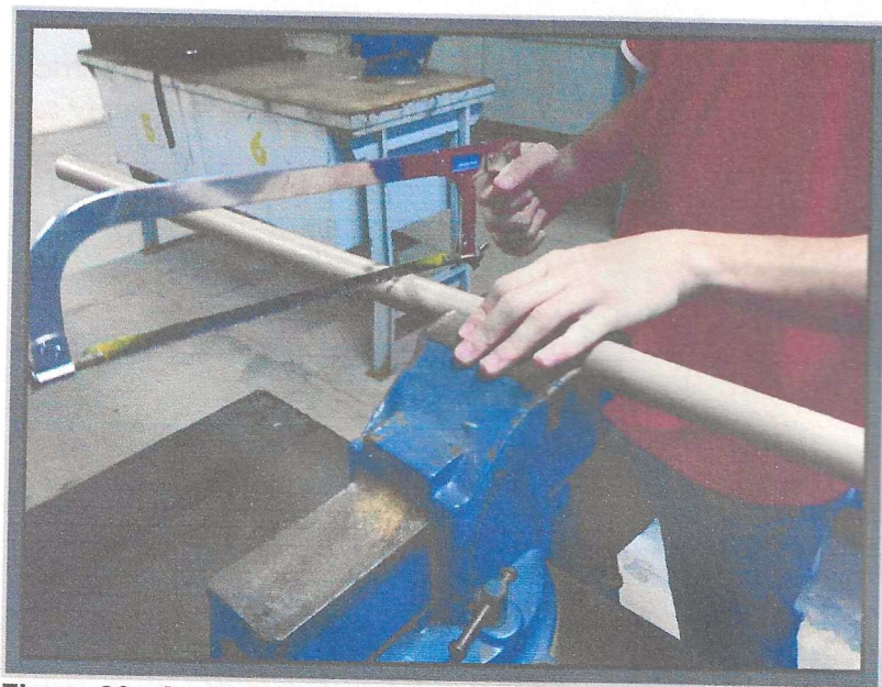
Figura 26 - Corte da tubulação
