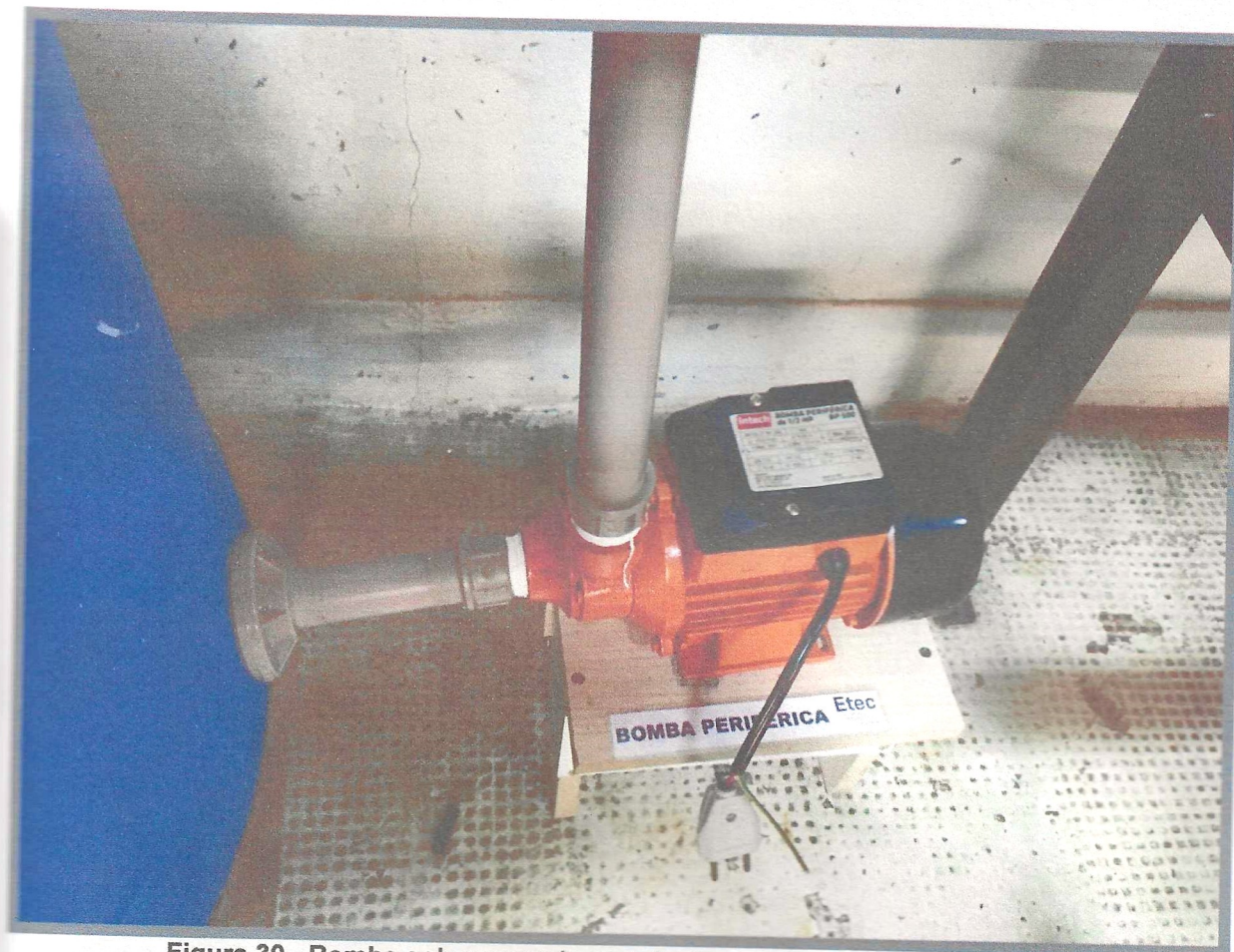
Figura 30 - Bomba sob o suporte para teste
