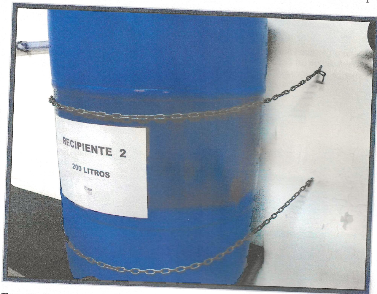
Figura 41 - Recipiente 2 travado por meio de correntes
