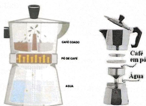
Figura 3 Funcionamento da mocha
