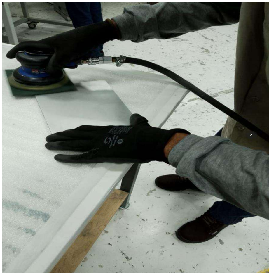
Figura 10 – Processo de preparação superficial do painel de alumínio aeronáutico.
