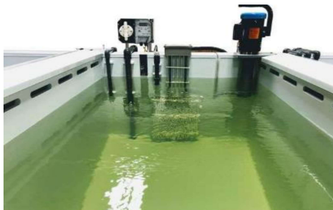
Figura 2 – Tanque de conversão química de Alodine.
