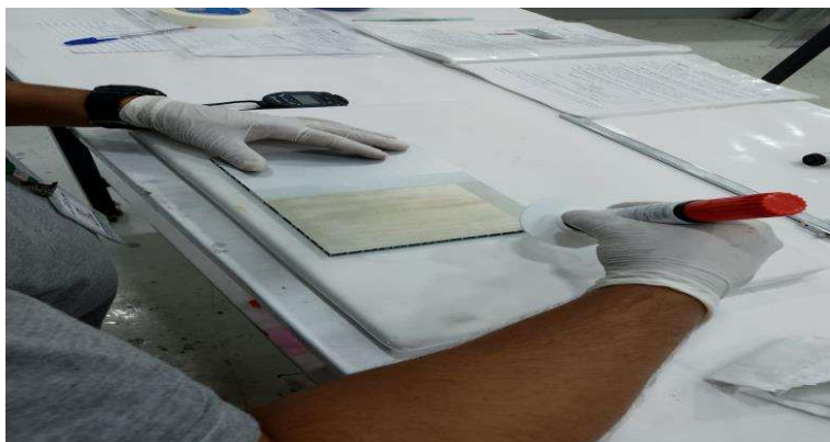
Figura 11 – Aplicação localizada do Bonderite M-CR 1132 Aero no painel de alumínio.
