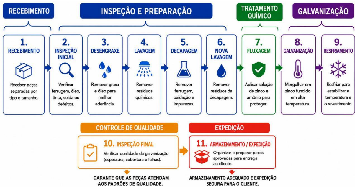
Figura 2- Fluxograma do processo de galvanização de acordo com pesquisas realizadas na empresa.
