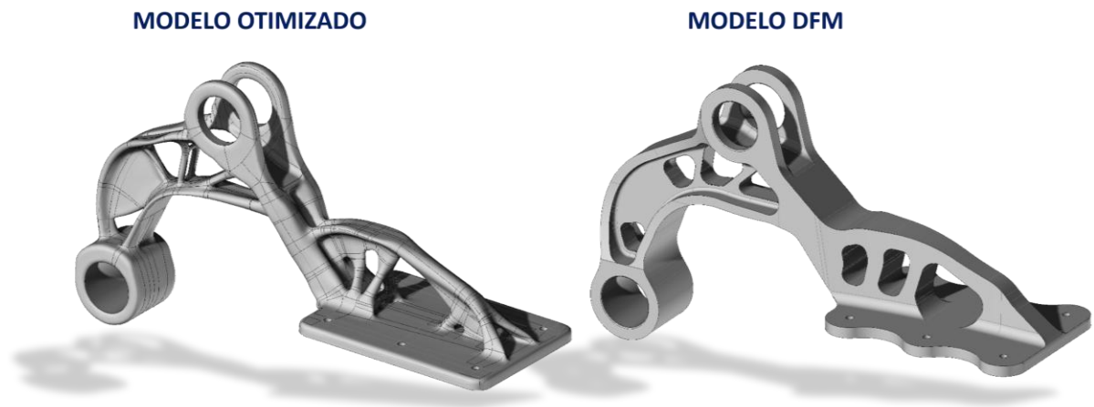
Figura 52. Comparação entre o modelo otimizado e o modelo com a aplicação do DFM.
