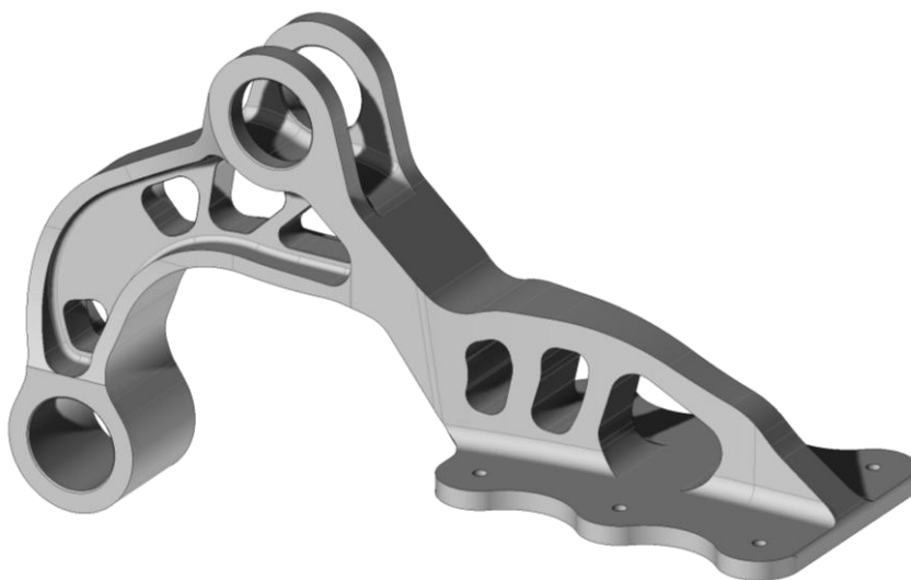
Figura 51. Geometria do componente após a aplicação do DFM.
