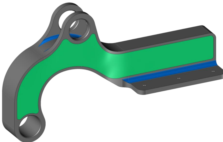
Figura 11. Preenchimento da peça indicado pela cor verde na figura.
