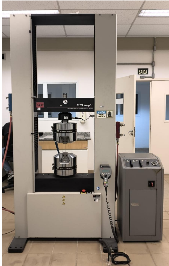
Figura 13. Máquina de Tração MTS INSIGHT
