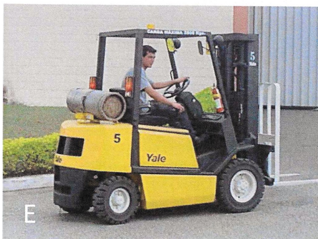
Empilhadeira frontal e Empilhadeira retrátil. Fonte: Saur Equipamentos S.A.
