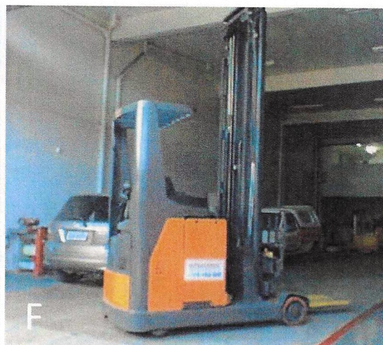
Empilhadeira frontal e Empilhadeira retrátil. Fonte: Saur Equipamentos S.A.
