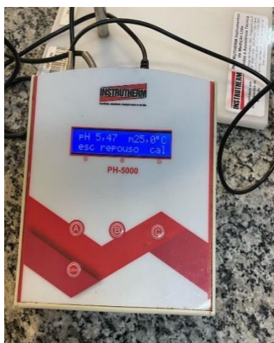
Figura 24 - pHmetro aferindo o pH do perfume
