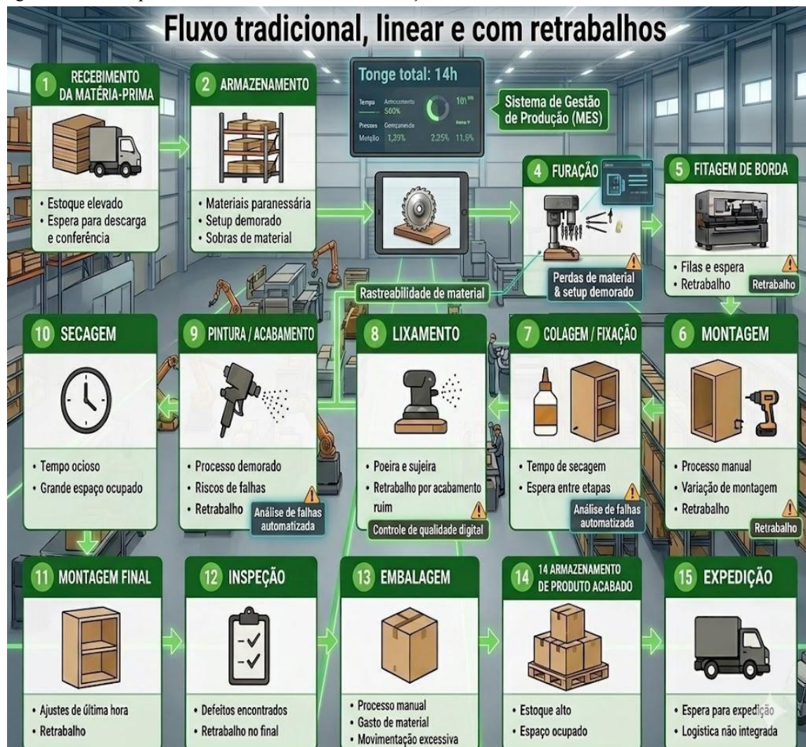
Figura 3 Processo produtivo moveleiro sem reestruturação
