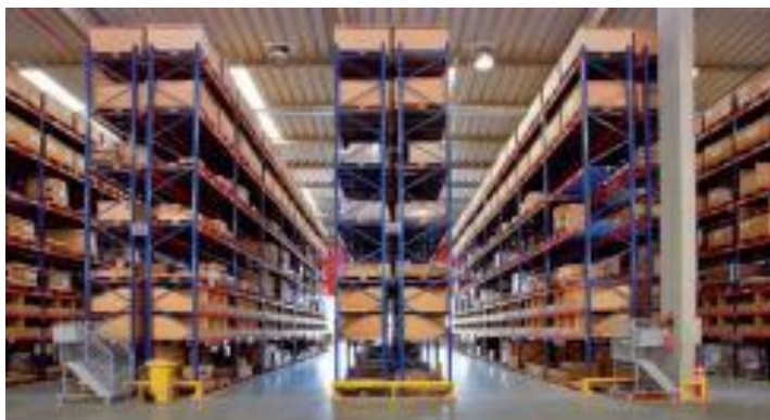
Figura 4 - Porta pallet de dupla profundidade.
