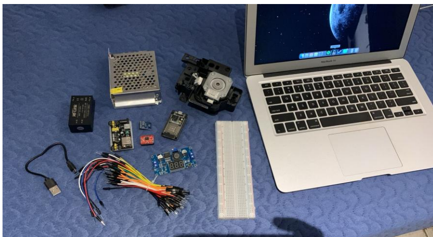
Fig. 1- Imagem do componentes utilizados para o protótipo desenvolvido (Protoboard, regulador de tensão, cabos específicos para protoboard, fonte 12V, adaptadores USB)
