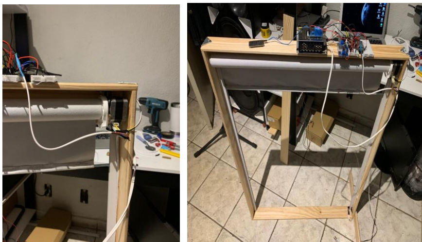
Fig. 6 e 7- Motor de Passo conectado a rolo da persiana; primeiro modelo de testes na moldura
