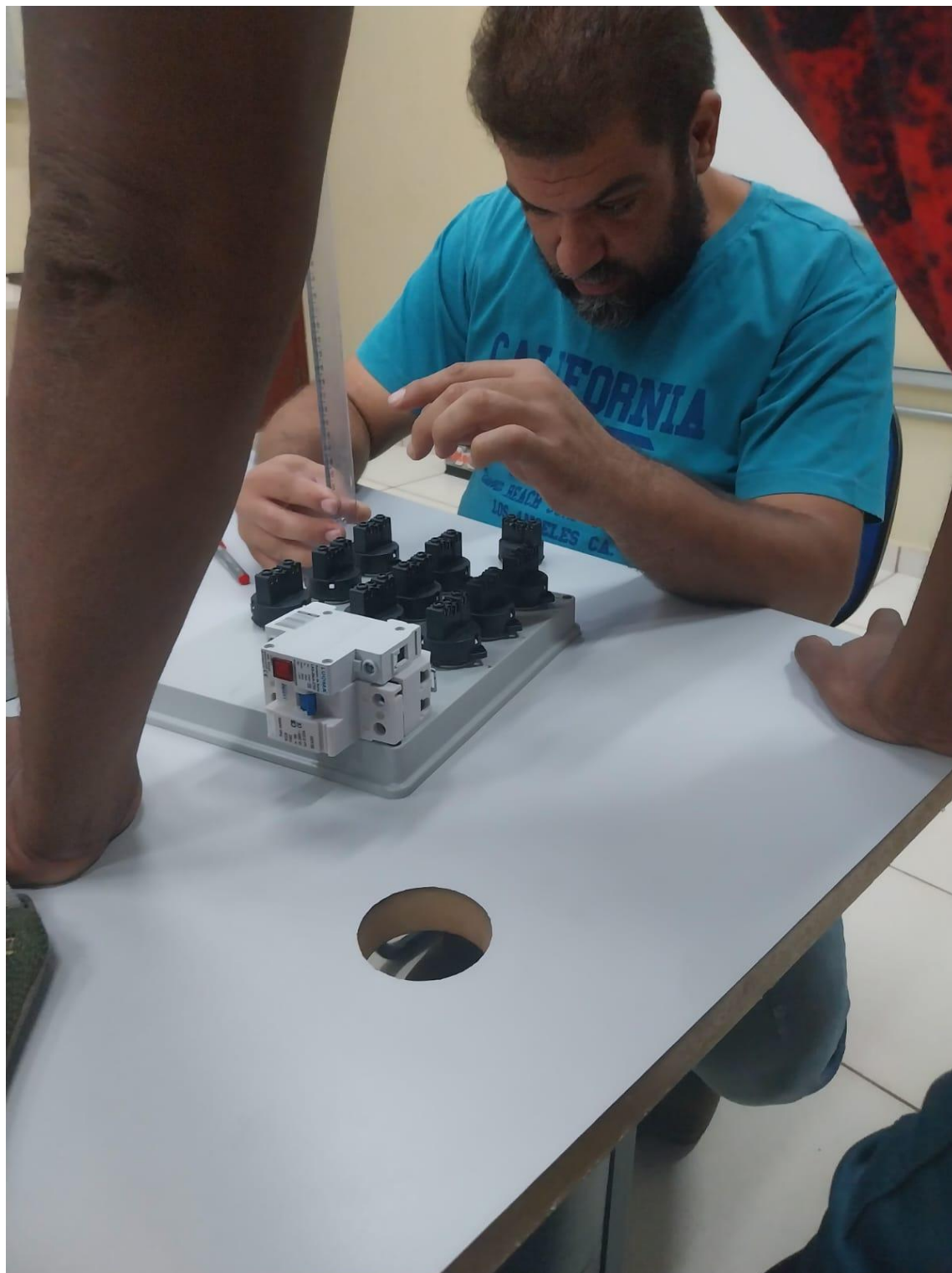
Figura 6: Etapa de medição técnica rigorosa, planejamento de layout e marcação dos furos no painel/caixa de tomadas para a acomodação e refrigeração do hardware de automação.
