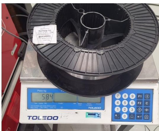
Figura 23 - Peso da bobina de arame tubular antes de realizar a soldagem
