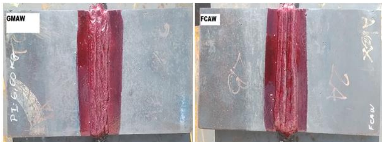
Figura 30 - Ensaio com líquido penetrante
