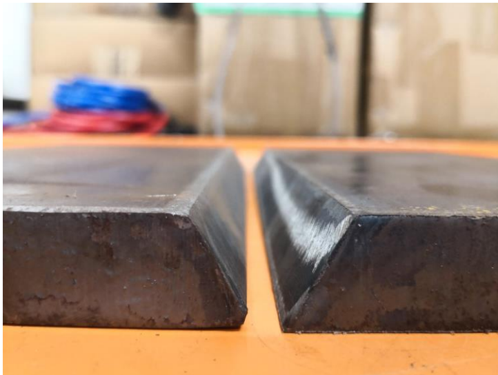
Figura 19 - Chanfro das chapas utilizadas para confecção dos corpos de prova
