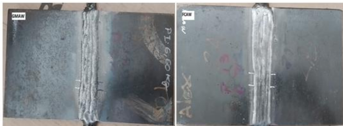
Figura 29 - Preparação dos corpos para ensaio END
