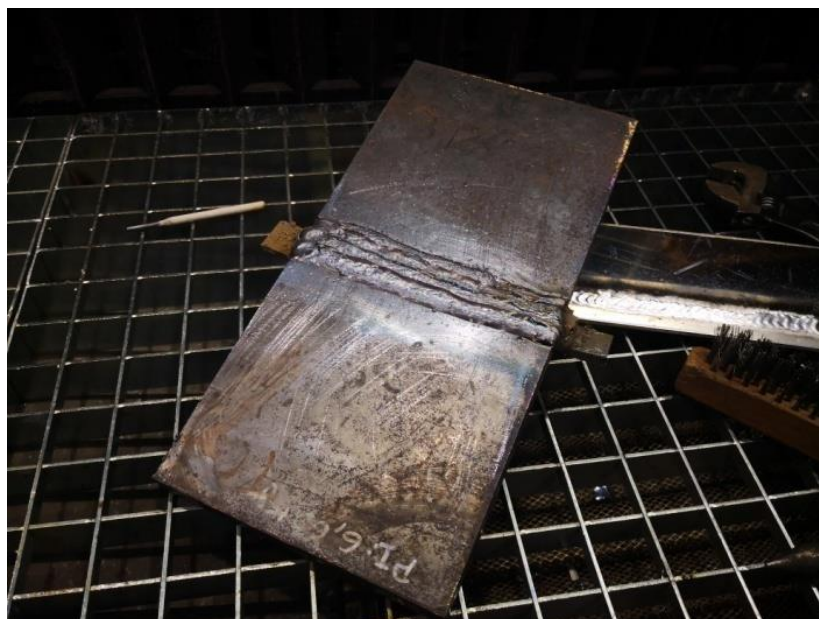
Figura 25 - Corpo de prova GMAW Soldado
