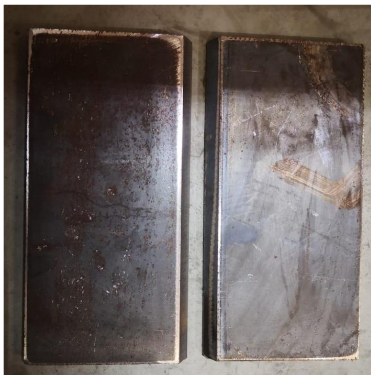
Figura 16 - Corte das chapas para confecção dos corpos de prova
