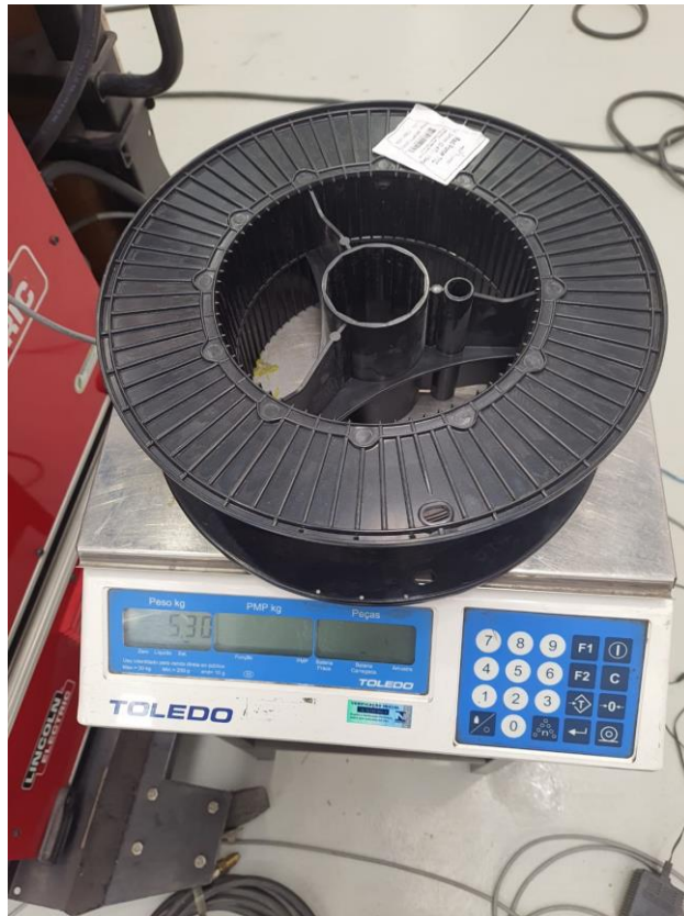
Figura 28 - Peso da bobina FCAW após a soldagem
