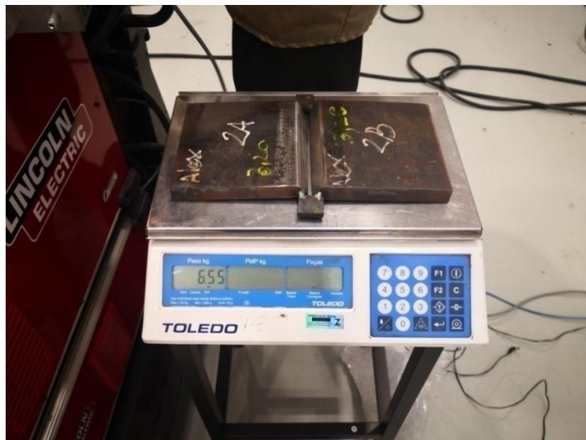
Figura 21 - Peso corpo de prova FCAW antes da Soldagem
