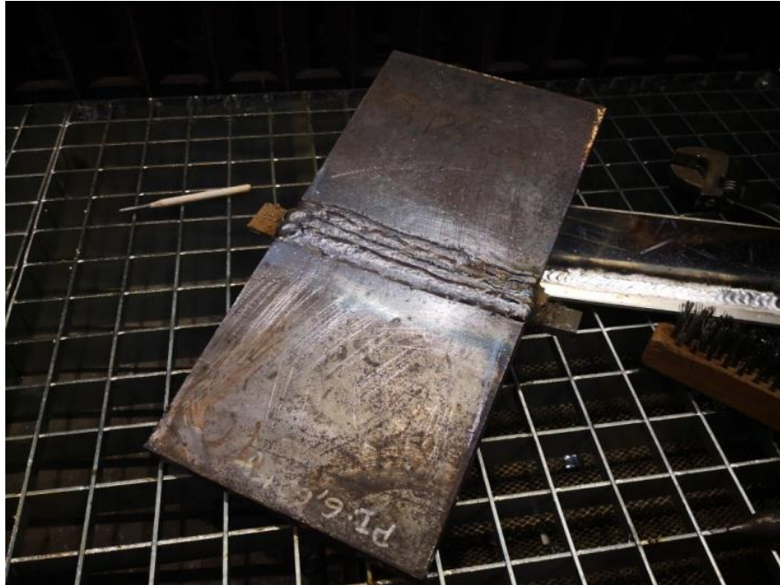
Figura 26 - Corpo de prova FCAW Soldado
