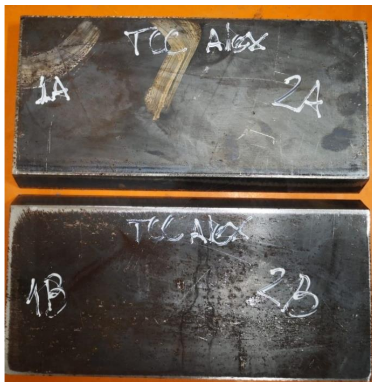
Figura 17 – Corte das chapas para confecção dos corpos de prova (2)
