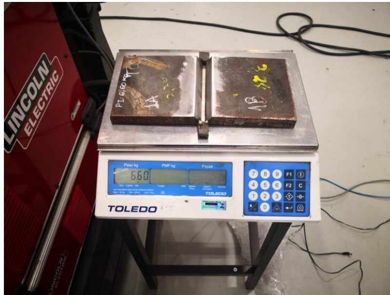
Figura 20 - Peso corpo de prova GMAW antes da soldagem
