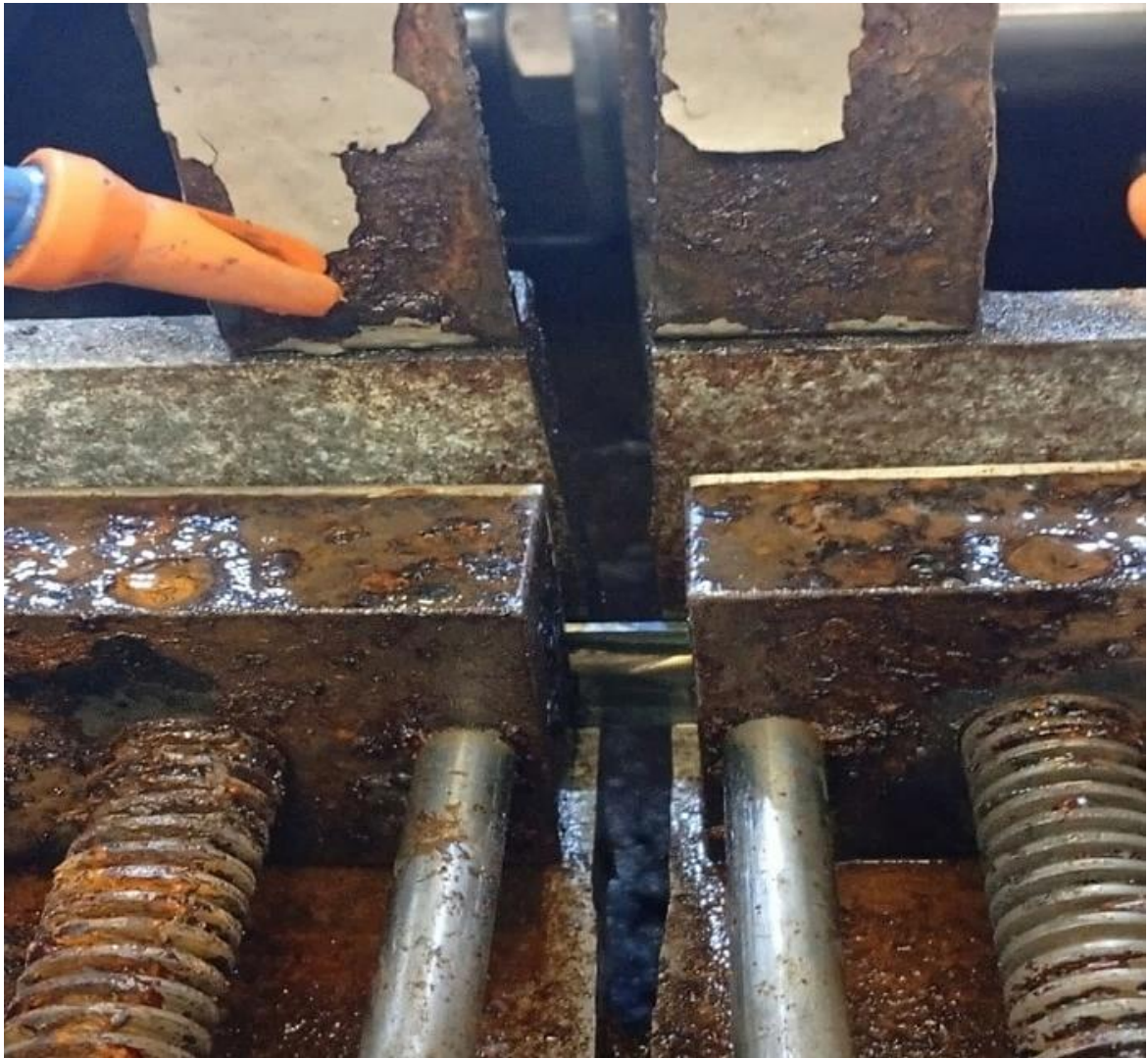
Figura 67- Corte feito em uma Cut-Off para o embutimento
