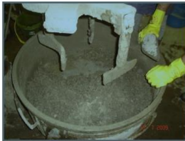
Figura 5: Aspecto da massa do concreto de um traço com relação a/c Fonte: Hölztz 2011
