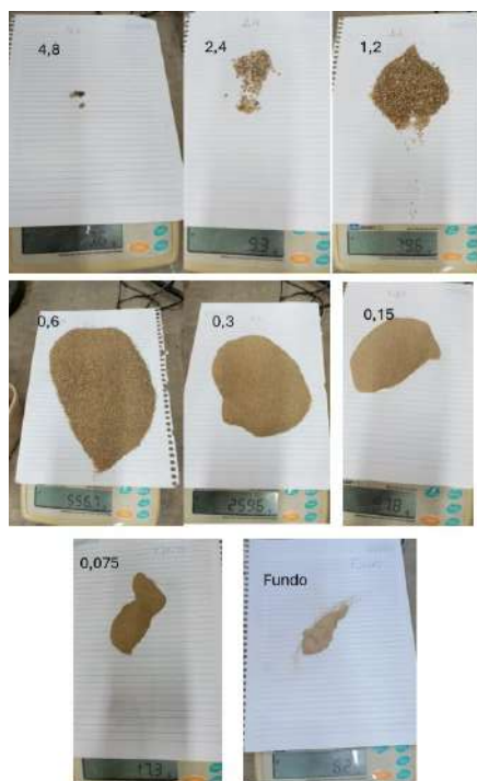
Figura 25 - Amostras retidas em cada série de peneira granulométrica
