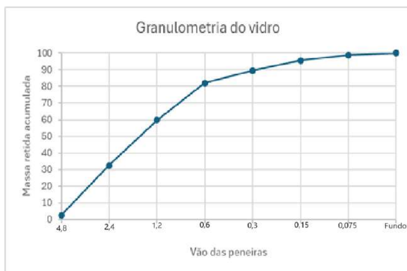
Gráfico 3 - Representação da massa de areia retida acumulada (NM 248)
