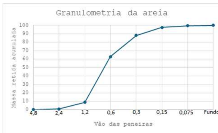
Gráfico 2 - Representação da massa de areia retida acumulada (NM 248)
