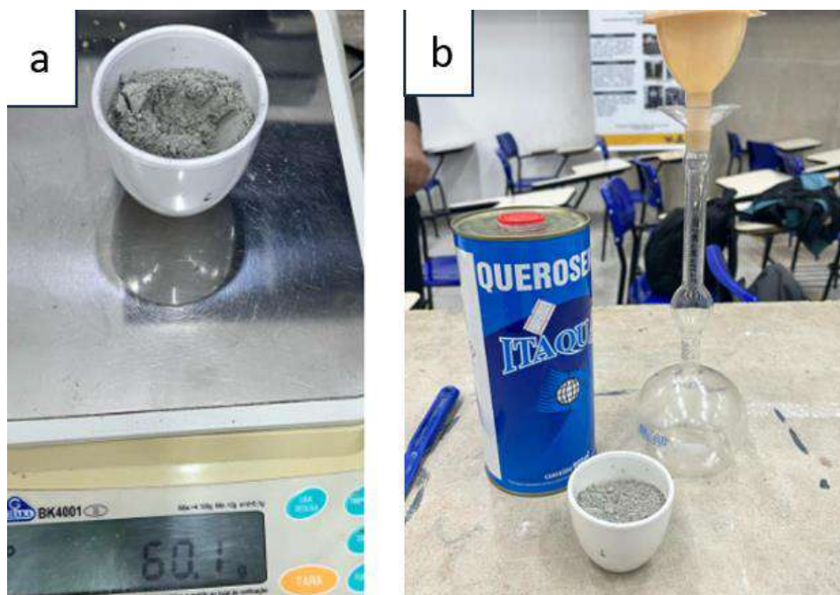
Figura 5 – Ensaio de massa específica real do cimento com frasco Le Chatelier (a) pesagem da amostra de cimento; (b) materiais utilizados: amostra de material, querosene, funil e frasco Le Chatelier .
