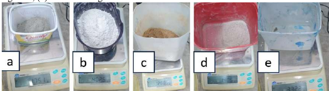
Figura 13 – Materiais analisados para o traço 2 (10% de substituição). (a) amostra de CP II F 32; (b) amostra de CH III; (c) amostra de areia grossa; (d) amostra de vidro grosso; (e) amostra de água
