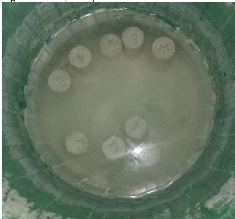
Figura 19 - Corpos de prova em cura final em cuba saturada em água e cal
