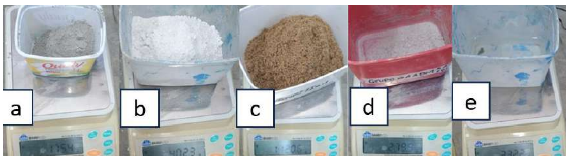
Figura 14 - Materiais analisados para o traço 3 (20% de substituição). (a) amostra de CP II F 32; (b) amostra de CH III; (c) amostra de areia grossa; (d) amostra de vidro grosso; (e) amostra de água
