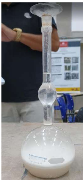
Figura 24 - Resultado do ensaio de massa específica da cal hidratada
