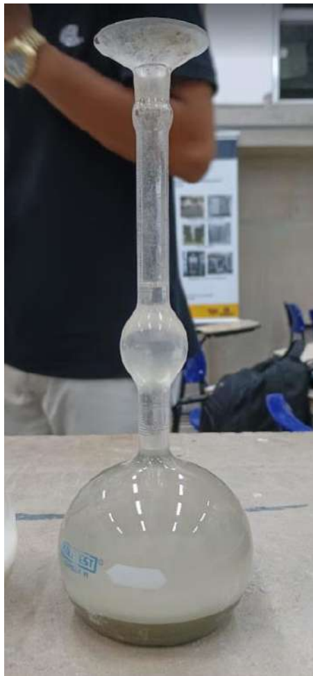
Figura 21 – Ensaio de massa específica real do cimento (NBR 16605 – 2017)
