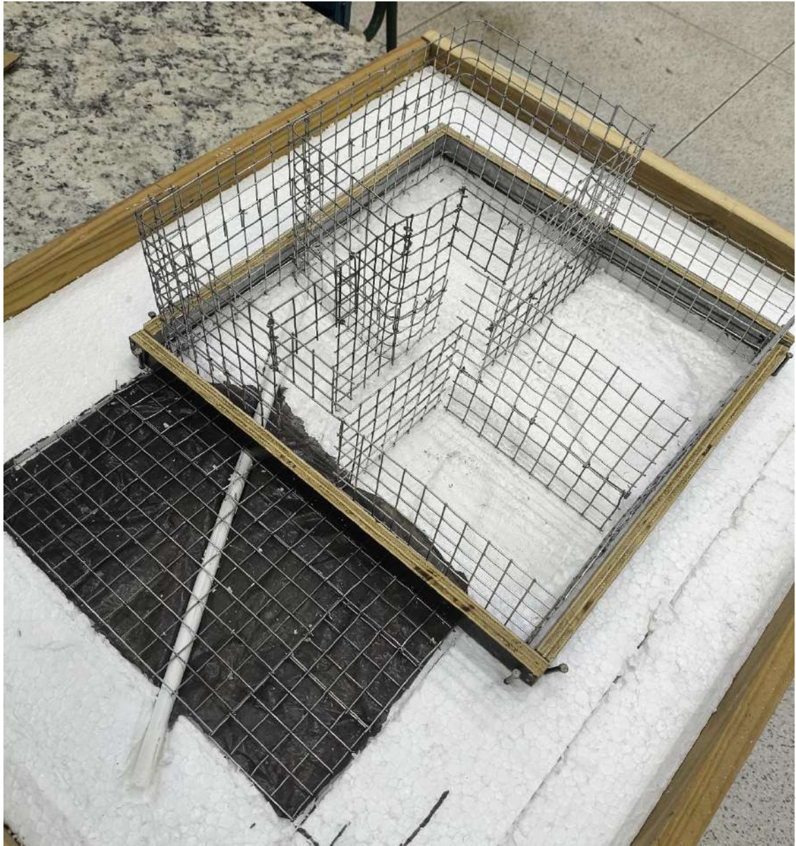
Imagem 8: Armadura das Paredes
