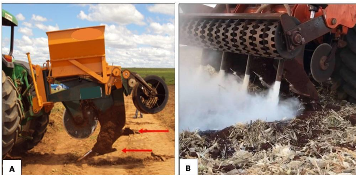
Figura 8 – Implementos para a incorporação de insumos em profundidade sem pressão (A) e submetido à pressão usados no plantio do café.
