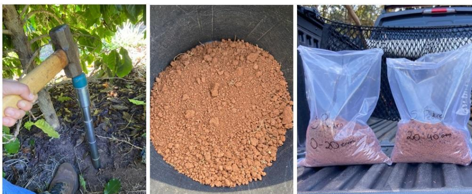
Figura 3 – Amostragem de solo para a análise química.
