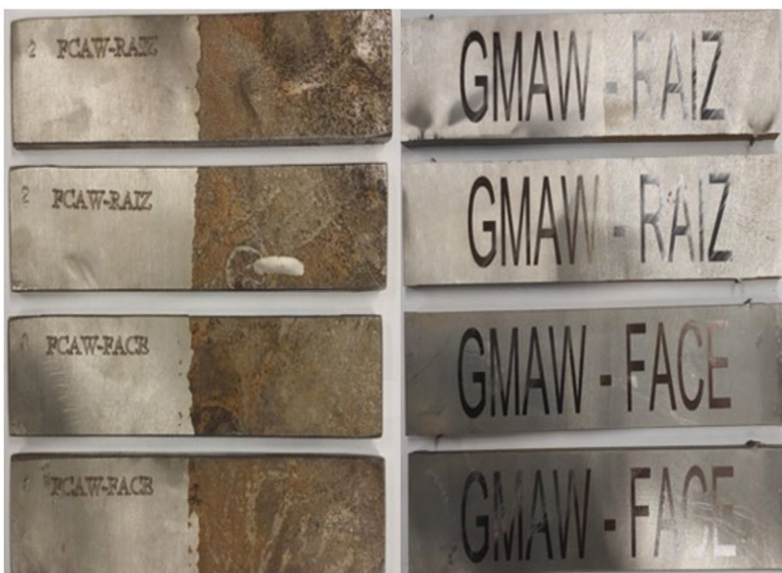
Figura 35 CP para ensaio de dobramento
