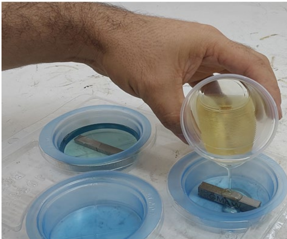
Figura 38 Aplicação da resina nos moldes
