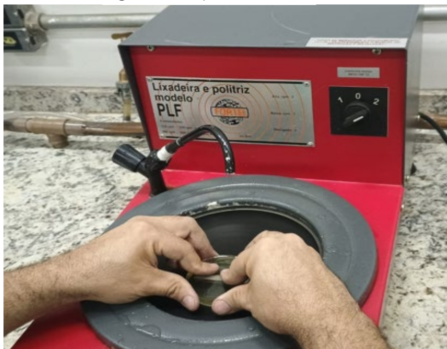
Figura 39 Etapa de lixamento
