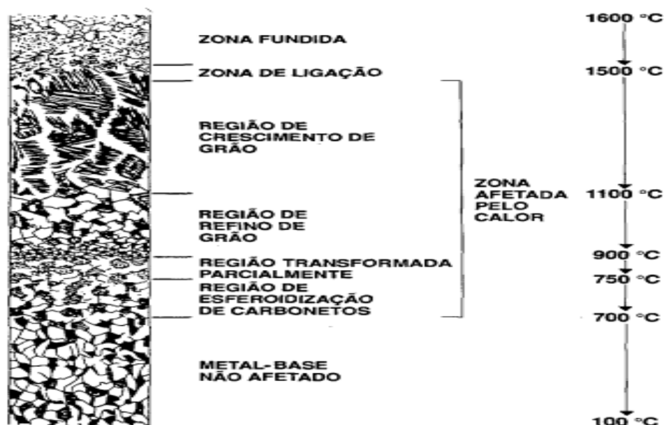
Figura 11 - Regiões da junta soldada
