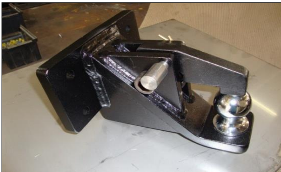
Figura 4 - Engate fixado no caminhão de coleta seletiva
