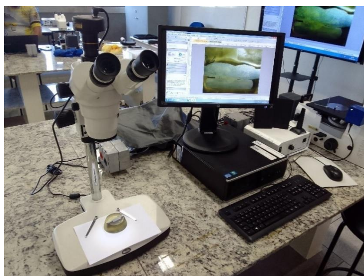
Figura 28 - Estereoscópio com Aumento de 40X.
