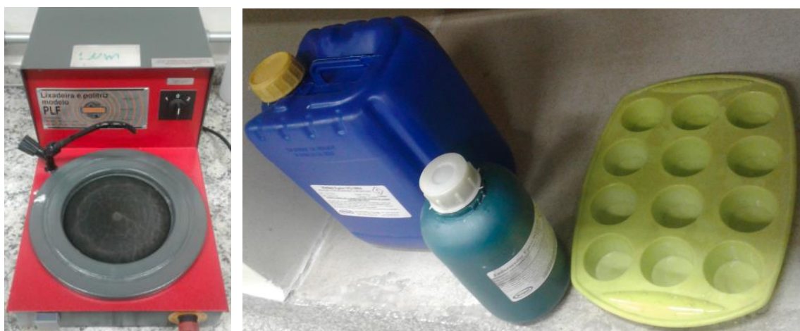
Figura 27 – Lixadeira/politriz e materiais de embutimento
