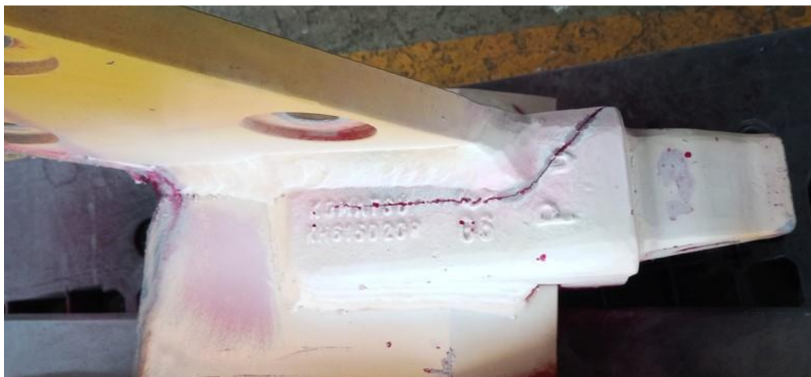
Figura 22 – Ensaio por líquido penetrante
