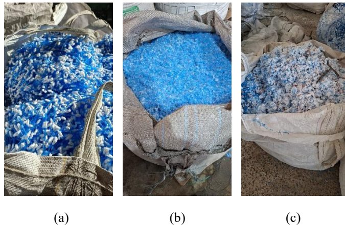
Figura 17: Separação de composto: (a) hastes trituradas; (b) fração polimérica; (c) algodão.
