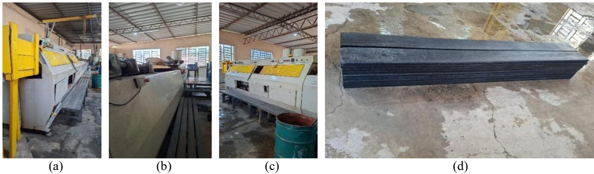
Figura 19: Extrusão de MP: (a) maquinário; (b) granulado; (c) saída; (d) produto final.
