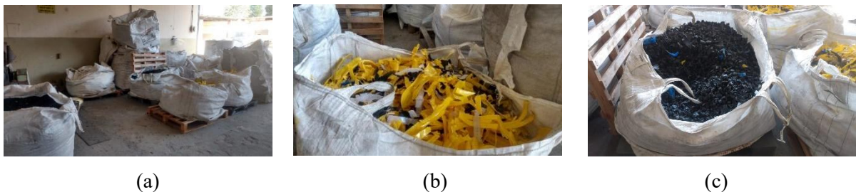
Figura 16: Insumos poliméricos: (a) recepção; (b) triagem; e (c) moagem.
