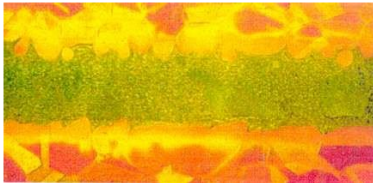
Figura 5 - Difusão molecular na junta brasada
