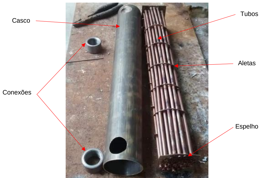
Figura 27– Montagem do trocador de calor
