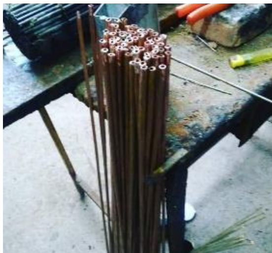
Figura 25– Tubo de cobre flexível ¼" conformado
