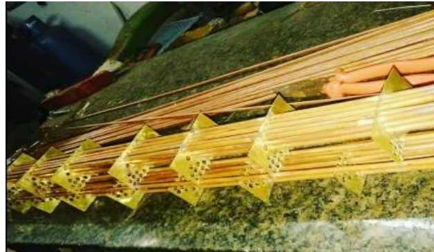
Figura 26– Montagem dos tubos e aletas
